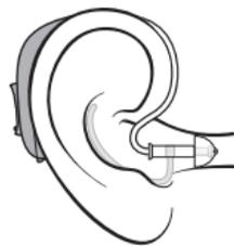
Appuyez doucement sur l'embout vers votre conduit auditif jusqu'à ce que le tube fin se loge dans votre oreille. Si le tube fin possède une pièce de maintien, placez-la dans l'oreille de façon à ce qu'elle suive le contour de l'oreille.
