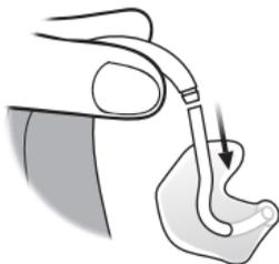
Déconnecter le tube et l'embout du coude. Tenez le coude fermement lorsque vous le détachez du tube. Sinon, l'aide auditive pourrait être endommagée.
